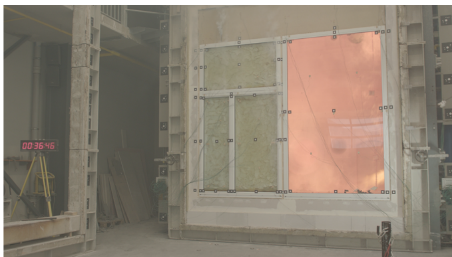
La finestra ignifuga in legno/alluminio EgoKiefer, testata EI30, garantisce una resistenza al fuoco per almeno 30 minuti.
