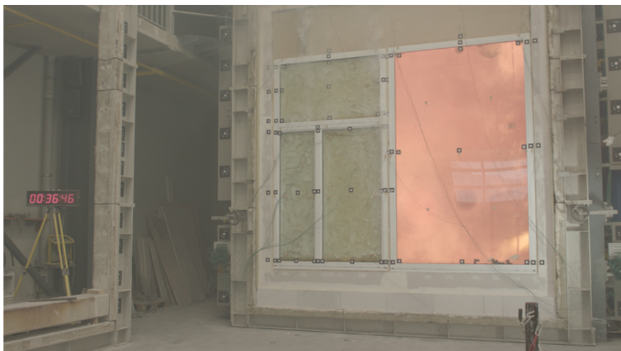
La fenêtre coupe-feu EgoKiefer bois/aluminium, contrôlée selon EI30, garantit une protection incendie durant au moins 30 minutes.
