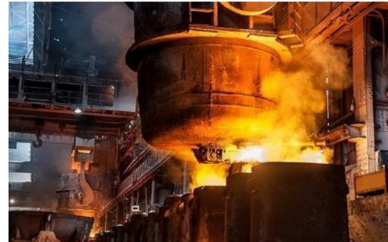
Schmelztemperatur Stahl bei 1500°C
