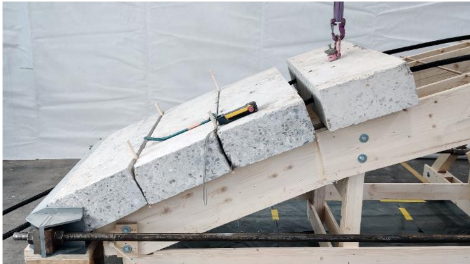
Fussgängerbrücke aus ReUse Beton-Elementen. EPFL, Structural Xploration Lab, Prof. C. Fivet
